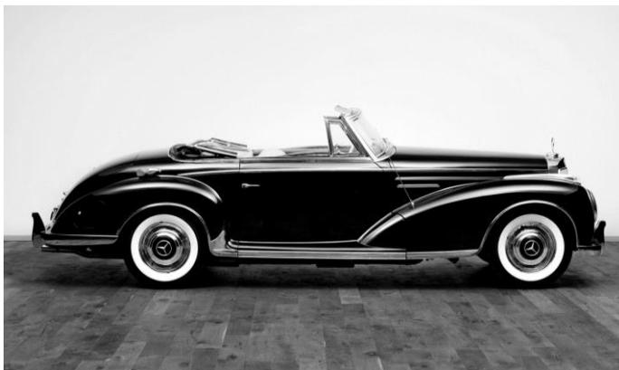
Direkteinspritzung – wie im sportlichen 300 SL – betrug die Leistung nun 175 PS. Die aufwendige Einspritzung war das Highlight im Serienfahrzeugbau und wurde mit einer EINSPRITZMOTOR-Gravur auf der hinteren Stoßstange betont. Das Fahrwerk hatte wie der 300c eine Eingelenk-Pendelachse mit tiefliegendem Drehpunkt für eine deutlich bessere Straßenlage.
