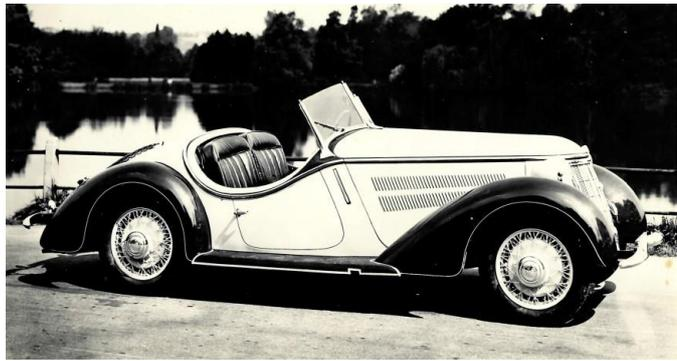
Solex-Vergasern und angepasstem Sportauspuff auf 85 PS gesteigert. Als einziges Wanderer-Modell erhielt der Typ W25 K ein Motorgehäuse aus Leichtmetall. So erzeugte der Motor eine Leistung von 85 PS und ermöglichte eine Höchstgeschwindigkeit von 150 km/h. Damit hatte der W 25 K eine um 5 PS höhere Leistung als sein direkter Konkurrent BMW 328.
