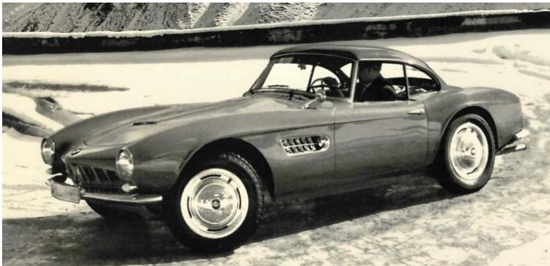
Herbst 1956 anlaufen. Der Wagen basiert auf dem verkürzten Rahmen des BMW 502 und wird von einem V8-Motor mit 3,2 Liter Hubraum befeuert, der 150 PS leistet (eine 165 PS-Version war optional erhältlich). Das Motorgehäuse besteht aus Aluminium. Ebenso die handgefertigte Karosserie – eine wohlproportionierte, schlanke und zugleich athletische Form mit langer Motorhaube und großen Rädern.
