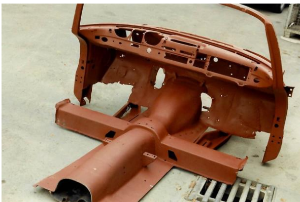
In diesem Zustand ist zu erkennen, wo und in welchem Umfang Bleche für die Instandsetzung angefertigt werden mussten (oben u. unten)
