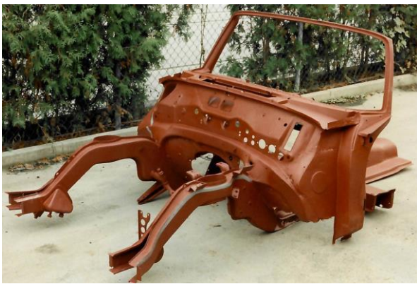
In diesem Zustand ist zu erkennen, wo und in welchem Umfang Bleche für die Instandsetzung angefertigt werden mussten (oben u. unten)
